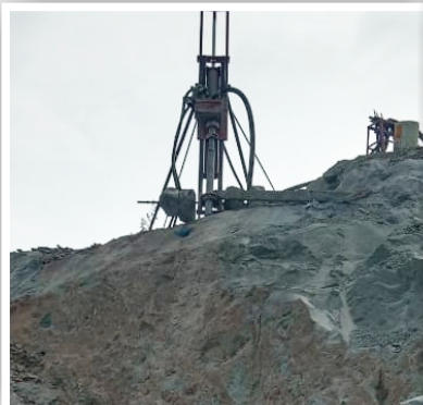
Pengeboran dengan DTH, Quarry Andesit Tegal Jawa Tengah
