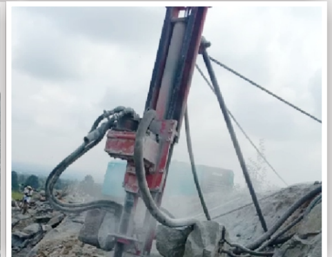
Pengeboran dengan DTH, Quarry Andesit Tegal Jawa Tengah
