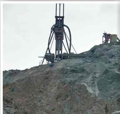
Penegeboran dengan DTH, Quarry Andesit Tegal Jawa Tengah
