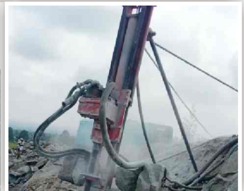
Penegeboran dengan DTH, Quarry Andesit Tegal Jawa Tengah
